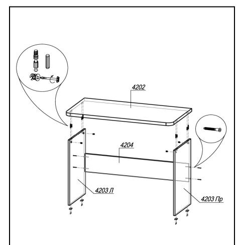
К бокам 4203Л и 4203Пр прибить подпятники гвоздями 2x20. В крышку 4202 установить шток эксцентрика (4 шт в деталь) в глухие отверстия Ø5мм и шкант (4 шт в деталь) в глухие отверстия Ø8мм. Соединить вязку 4204 (используя евровинты) и крышку 4202 с боками 4203Л и 4203Пр, установить эксцентрик Minifix (по 2 шт в бок) и закрепить шток эксцентрика. Закрыть эксцентрики и евровинты заглушками.
